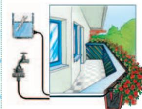
**TIPP:** Einen 2-Wege-Verteiler an den Wasserhahn und schon haben Sie einen zweiten Abgang.
