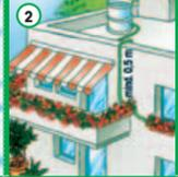
2 Falls nur ein Hochtank in Frage kommt, muss dieser **je 5 m Schlauchlänge mindestens 0,5 m höher als die Tropf-Blumat-Anlage stehen**. Bei 10 m Schlauch also mindestens 1 m.
