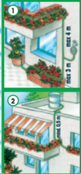
1 Wir empfehlen Ihnen den Anschluss am Wasserhahn mit Druckreduzierer. Befindet sich der Wasserhahn im Garten, dann können auch die Balkon- und Ampelpflanzen in maximal 4 m Höhe versorgt werden. Die Arbeit des Hochtanknachfüllens erübrigt sich somit.
