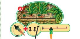
Bei Pflanzen gleicher Art können Sie anstelle eines zweiten Tropf-Blumat eine Kette mit maximal 5 Verteiltropfern und Stützen anschließen. (siehe dazu Detaillierung „Verteiltropfer-Montage“)
