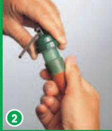
2 Gießkopf fest aufschrauben. Sensor muss luftdicht verschlossen sein.
