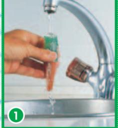
1 Grünen Gießkopf abschrauben und Keramiksensor randvoll mit Wasser füllen.
